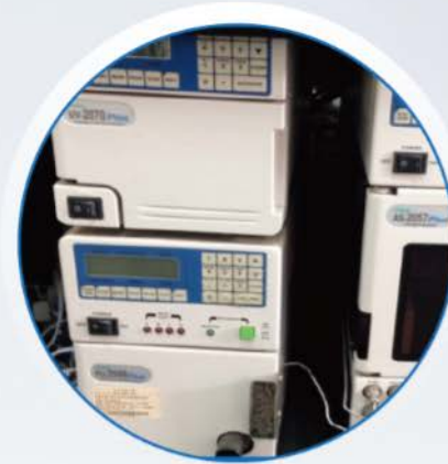
高效能液相層析儀(HPLC) 分析地下水有機污染物
