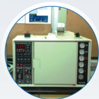
氣相層析儀(GC)分析排 廢氣中污染物濃度
