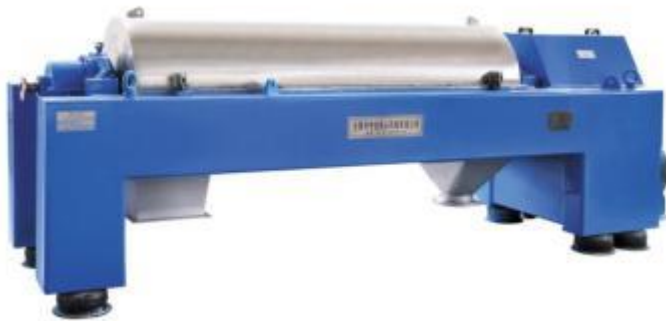
廢水處理廠板框式污泥脫水機 (上圖)，離心式污泥脫水機(下圖)
