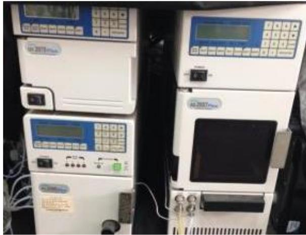
高效能液相層析儀(HPLC)分析地下水有機污染物
