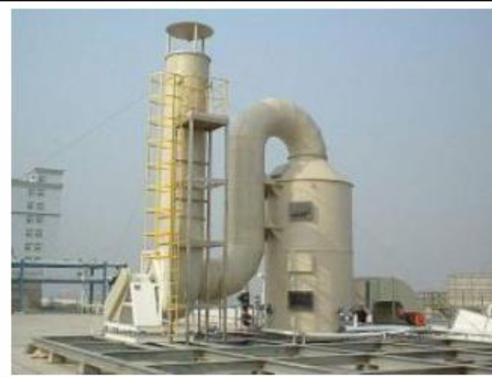
濕式洗滌塔捕捉廢氣的揮發性有機物、硫氧化物及氮氧化物
