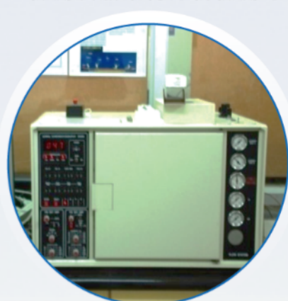
氣相層析儀(GC)分析排 廢氣中污染物濃度
